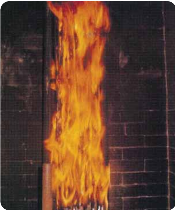
Alev iletme deneyinde standart PVC kablo
