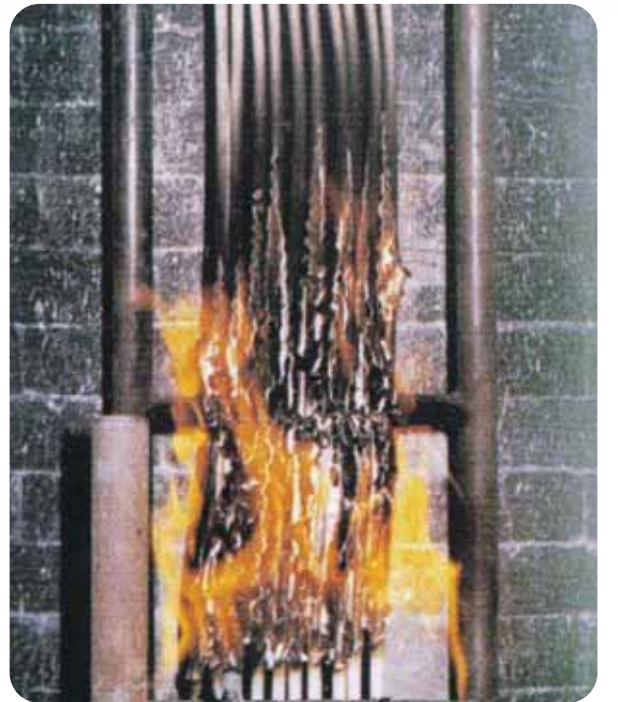
Alev iletme deneyinde AFUMEX™ kablo
